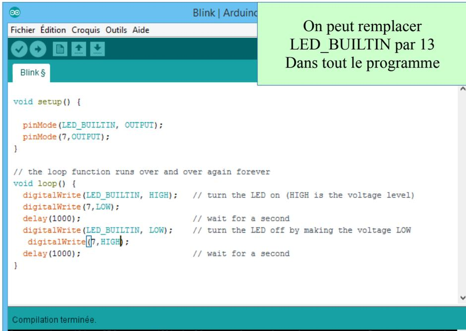
On peut remplacer LED\_BUILTIN par 13
