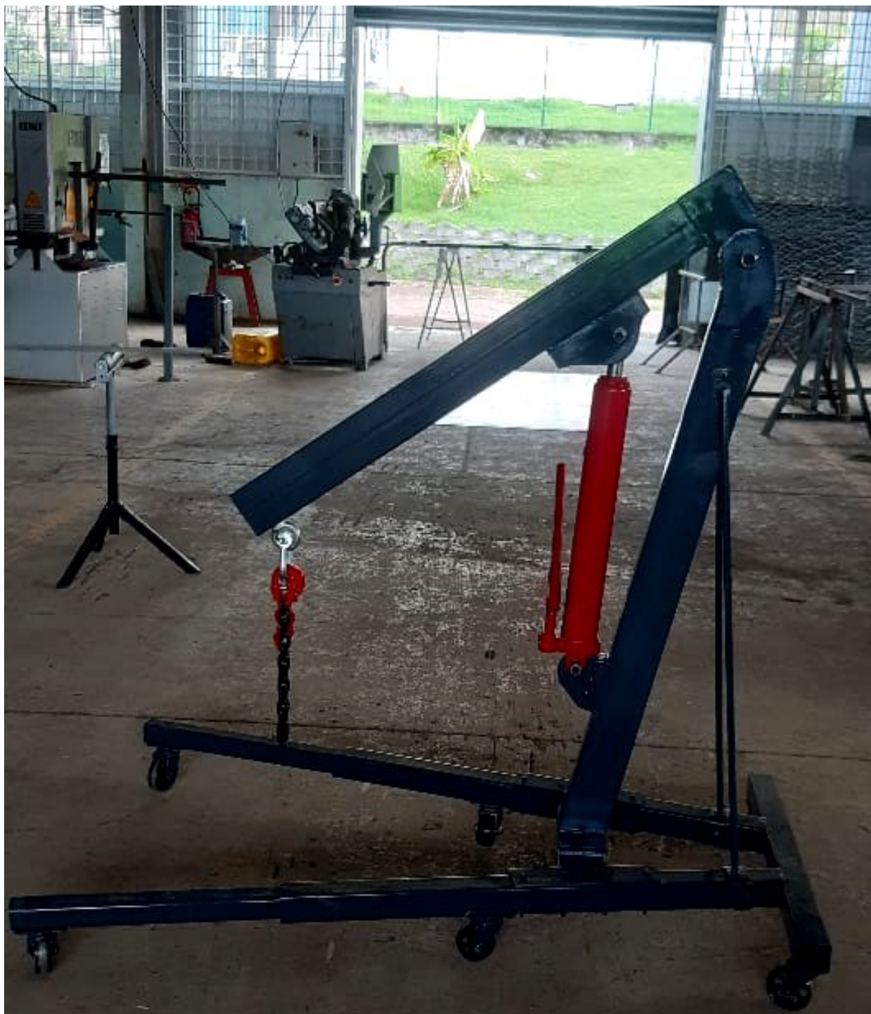
Chèvre en cours de certification avant mise ne service
