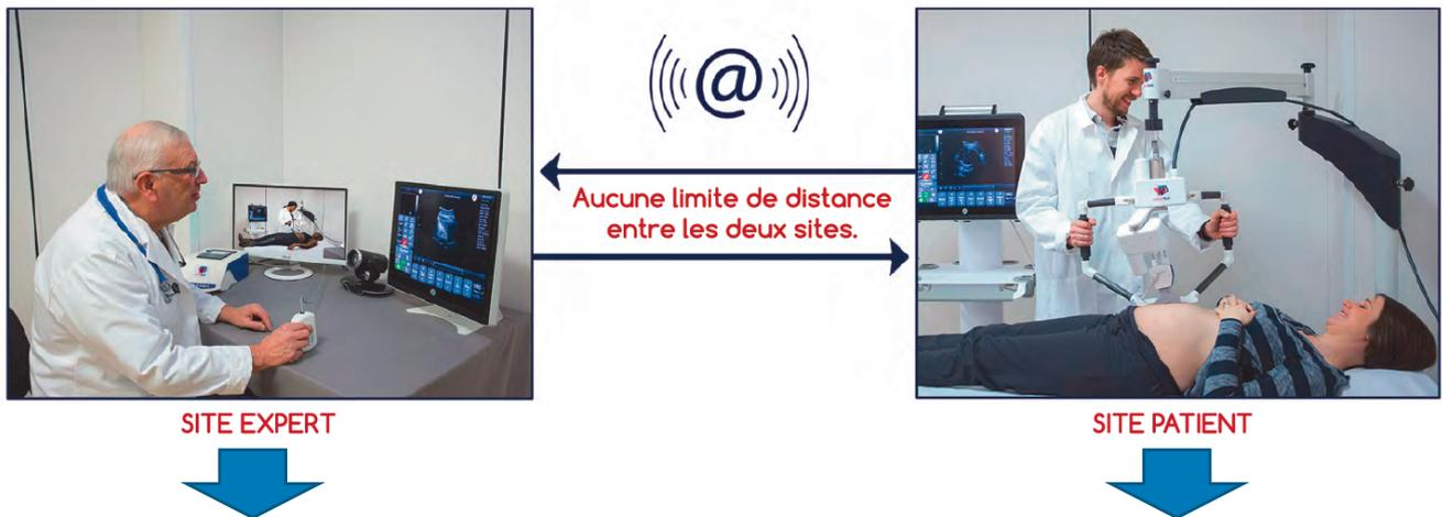
Un centre « expert » distant du lieu d'examen réel, avec un médecin « imageur » manipulant une « sonde fictive » similaire à une sonde réelle d'échographie, permet une prise de contrôle rapide et ergonomique à distance du robot.
