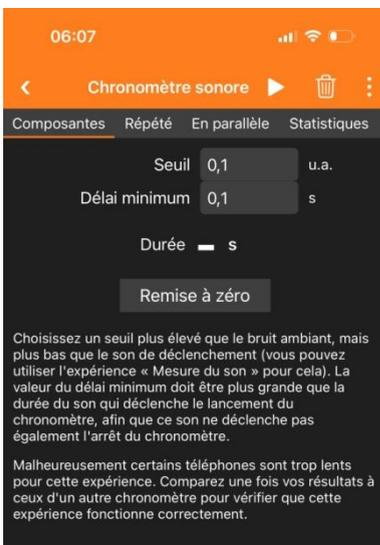
Le module **chronomètre sonore** de l'application phyphox installée sur un smartphone déclenche un chronomètre lorsque le microphone du smartphone détecte un signal sonore supérieur à un seuil de déclenchement défini par l'utilisateur. Le chronomètre s'arrête dans les mêmes conditions.
