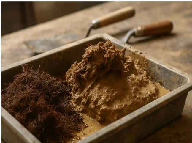
Préparation du mélange sargasses et argile pour briques biosourcées
