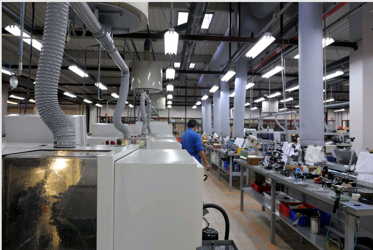
Vue générale d'un atelier d'usinage et de son système d'aspiration et de ventilation
