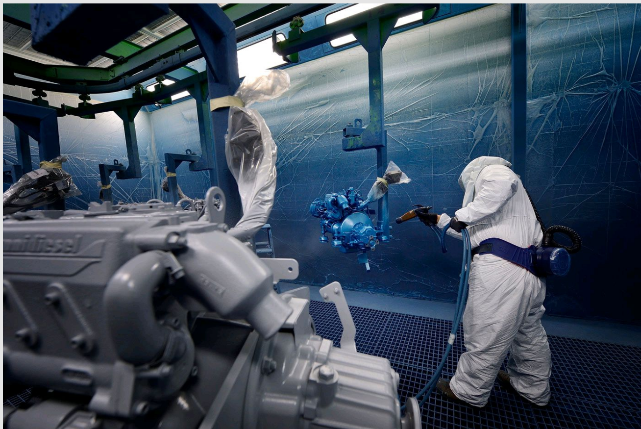
Cabine de peinture avec aspiration au sol
