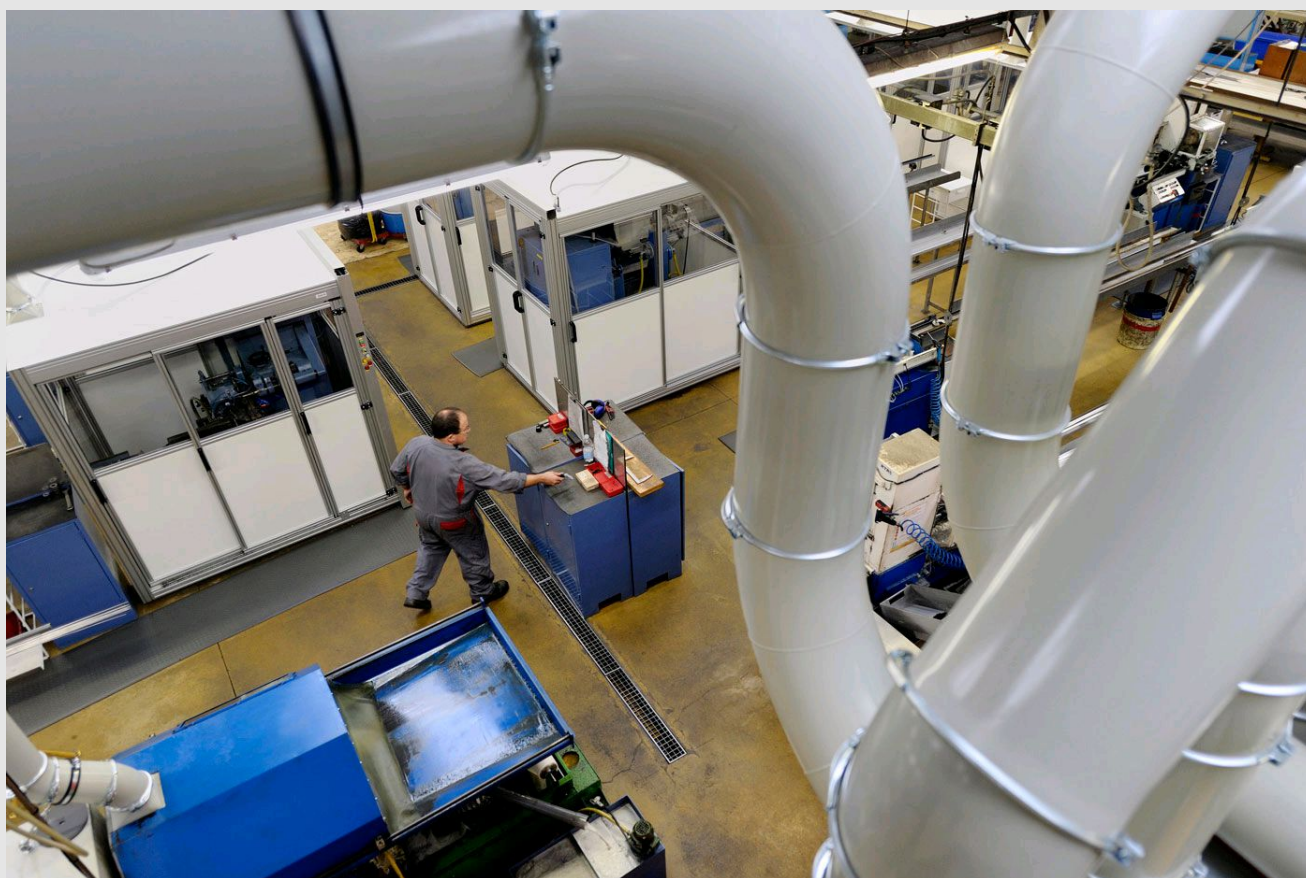
Vue générale du système d'aspiration dans un centre d'usinage de tubes métalliques
