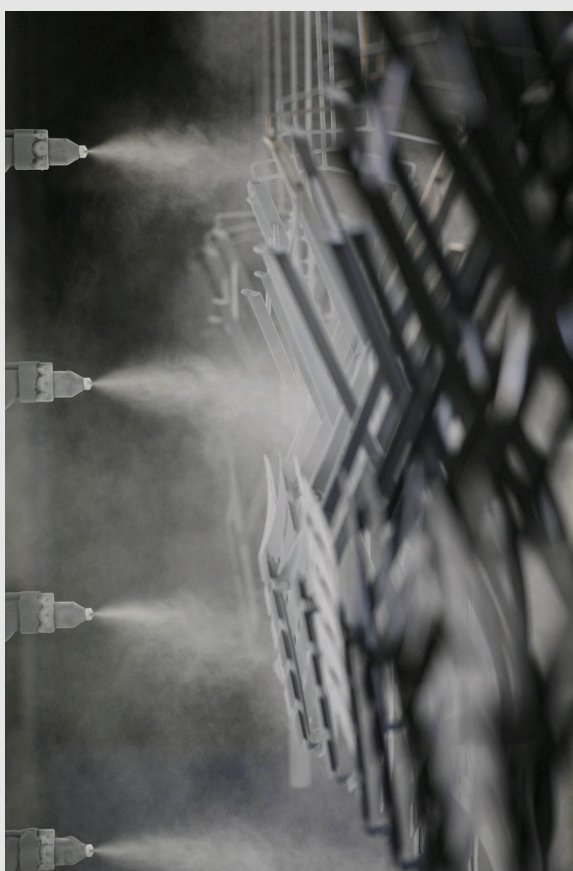
Cabine de peinture automatisée dans la fabrication de mobilier
