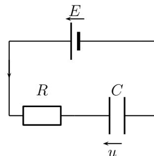
On note  $u$  la tension exprimée en volt aux bornes du condensateur. Cette tension  $u$  est une fonction du temps  $t$  exprimé en seconde.
