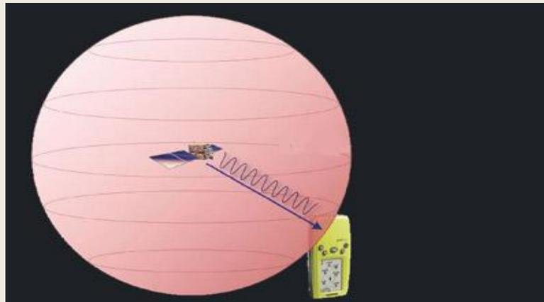
Le récepteur GPS sait alors qu'il se trouve en quelque part sur une sphère centrée sur le satellite  $S_1$
